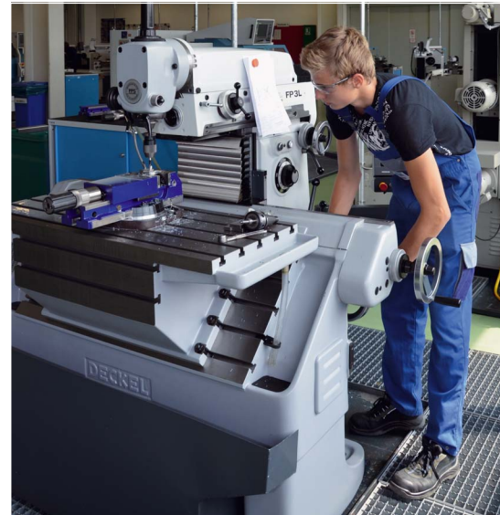
Die Deckel FP 3L sieht nach der Generalüberholung wieder aus wie neu
